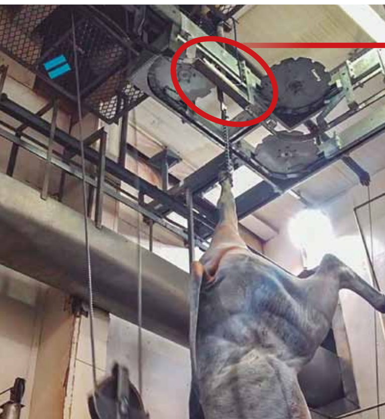
Módulo Ecotrace para coleta automática dos pesos coletados pela balança
